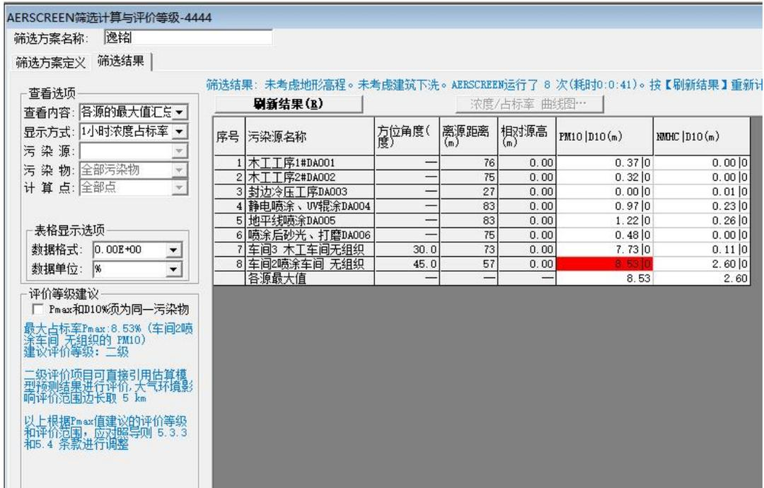
图 4-4-1 项目各污染源估算模式最大值汇总计算截图
